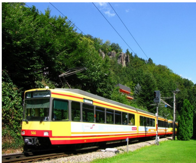
Duospåravn i Karlsruhe i Tyskland med två strömförsörjningssystem
